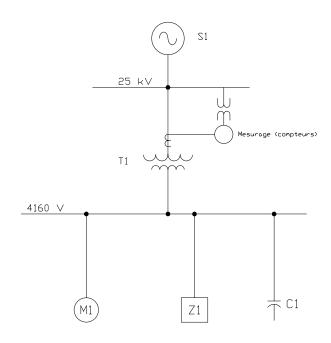
S1: Puissance de court-circuit triphasée du réseau 25 kV = 50 MVA
