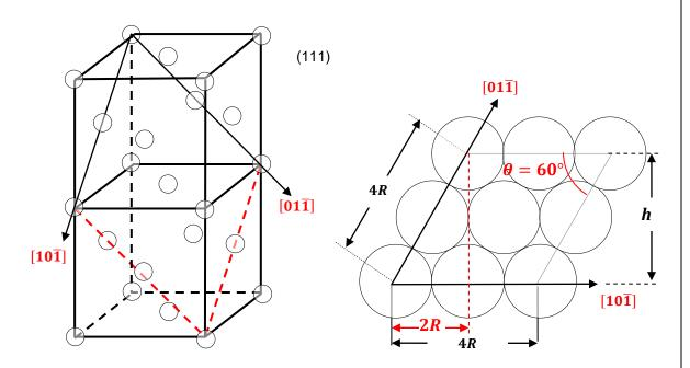
La hauteur h du parallélogramme est :  $h = \sqrt{(4R)^2 - (2R)^2} = 2\sqrt{3}R$  et la densité surfacique est :
